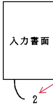
符号は、アラビア数字を用い、他の線と明確に区別することができる引出線を引いて付けます。
